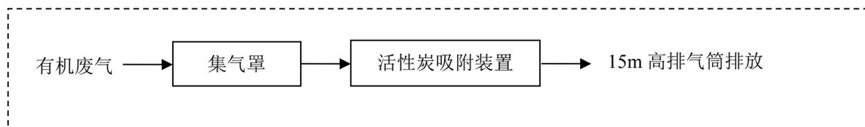
图 4-1 项目有机废气处理工艺流程图
