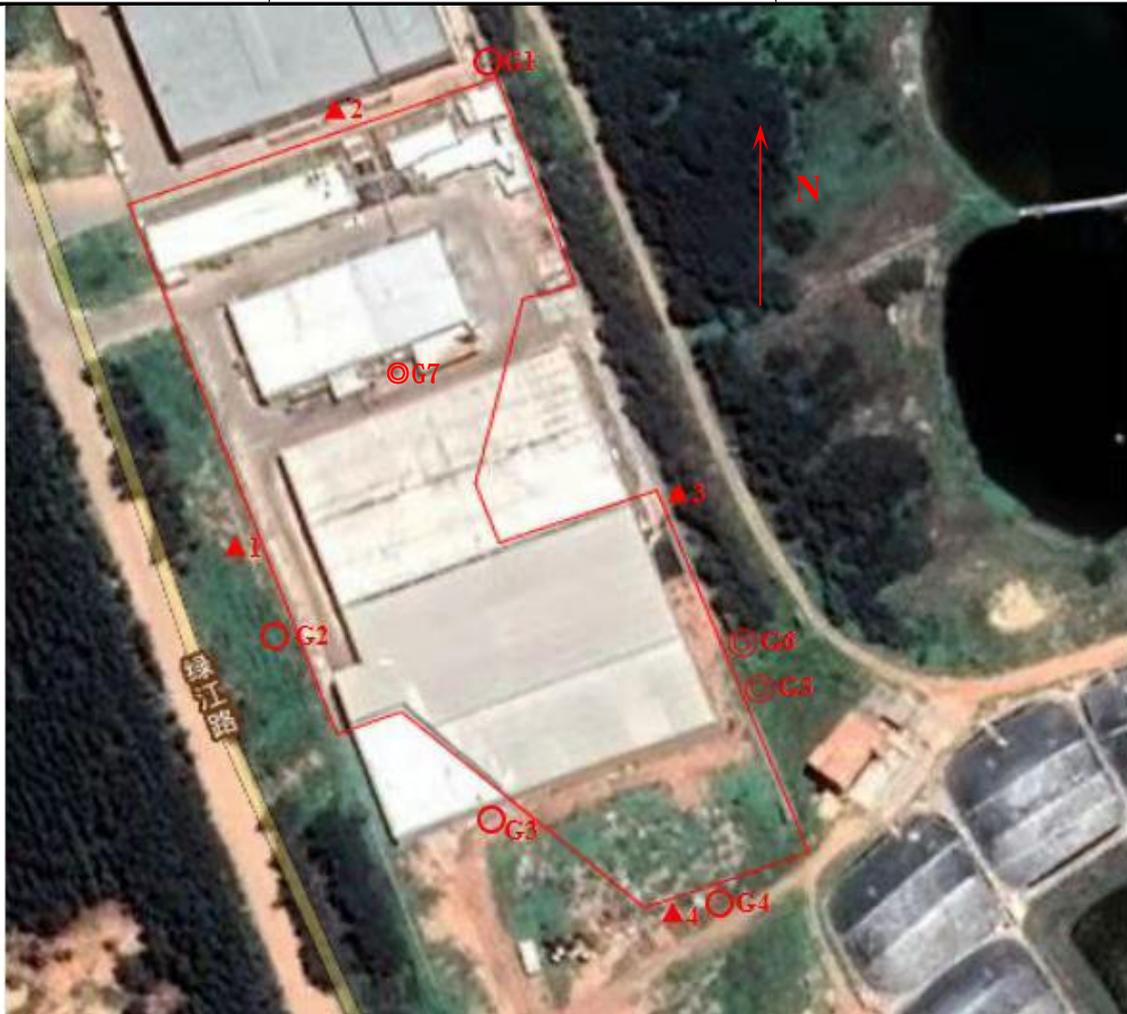
注：◎为有组织废气采样点位；○为无组织废气采样点位；▲为噪声采样点位。
